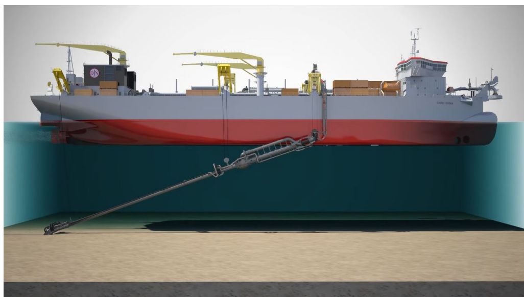
Figura 12: Draga de succión en marcha de fondo ( Jan de Nul )
