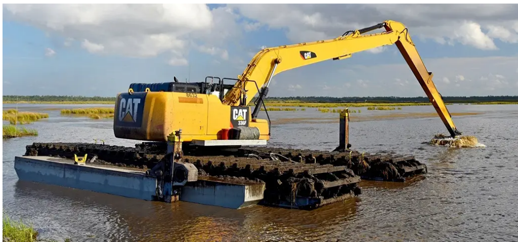
Figura 26: Excavadora anfibia ( Eddy Pump )
