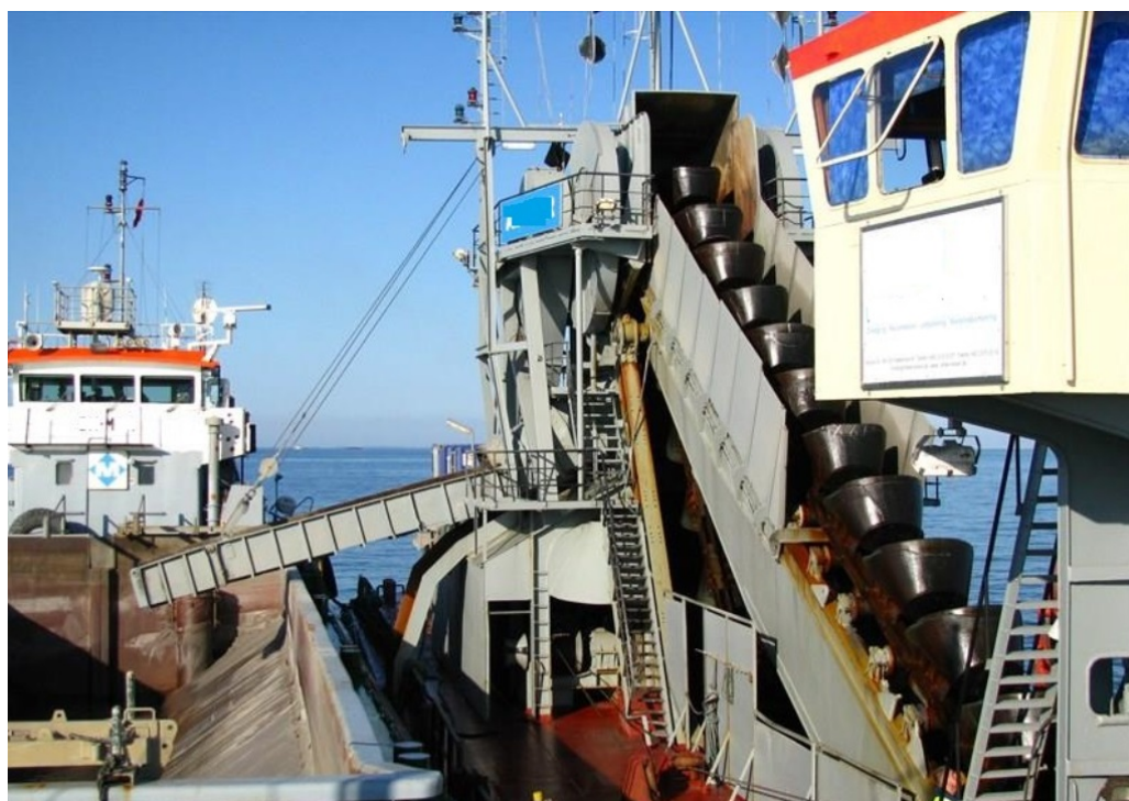
Figura 4: Descarga lateral de la draga a un pontón ( Pan Nova )
