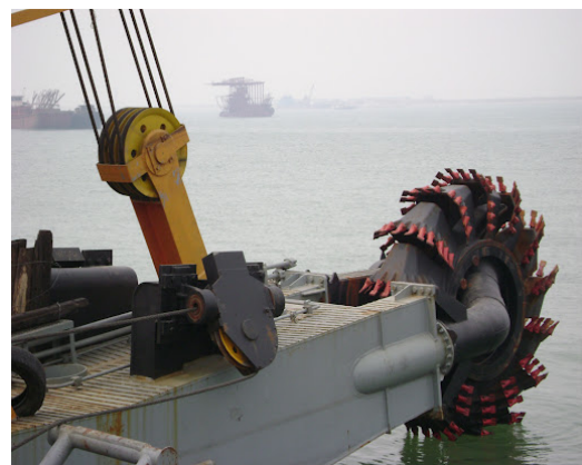
Figura 18: Cabezal cortador de rodete de cangilones ( Hi Sea Group )
