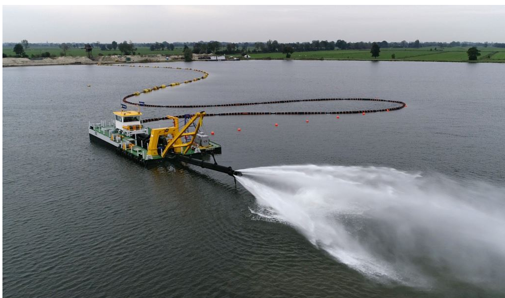
Figura 23: Draga con bomba de chorro (Vuyk Engineering)
