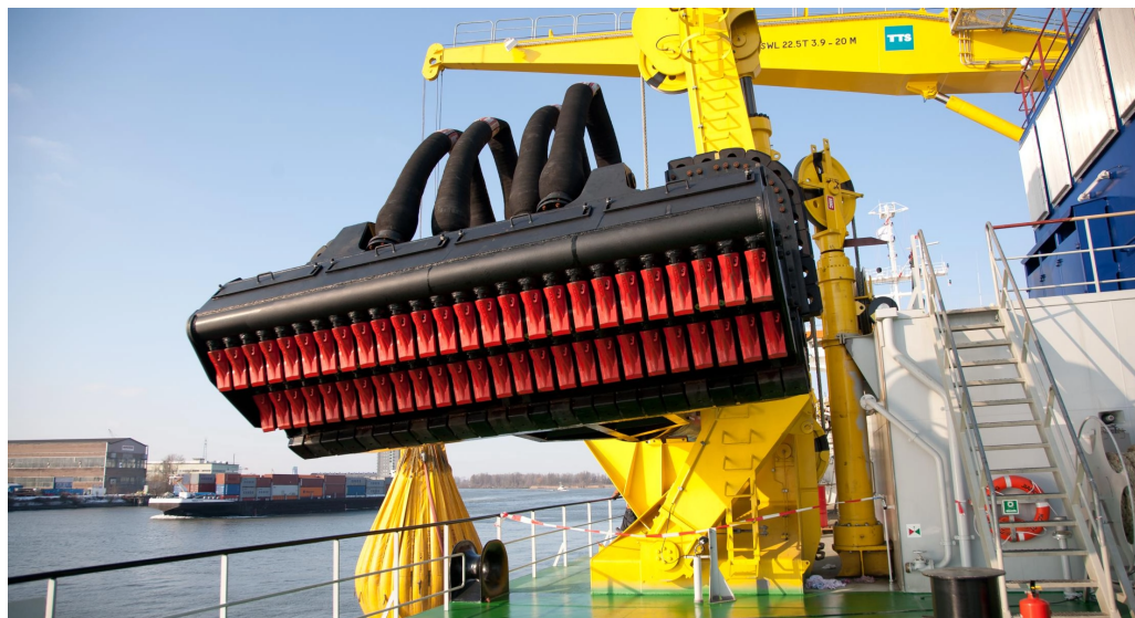
Figura 14: Cabezal de dragado (IHC Dredging)
