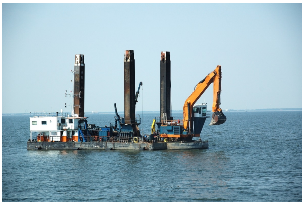
Figura 5: Draga retroexcavadora con tres spuds (VL Maritime Services Ltd.)
