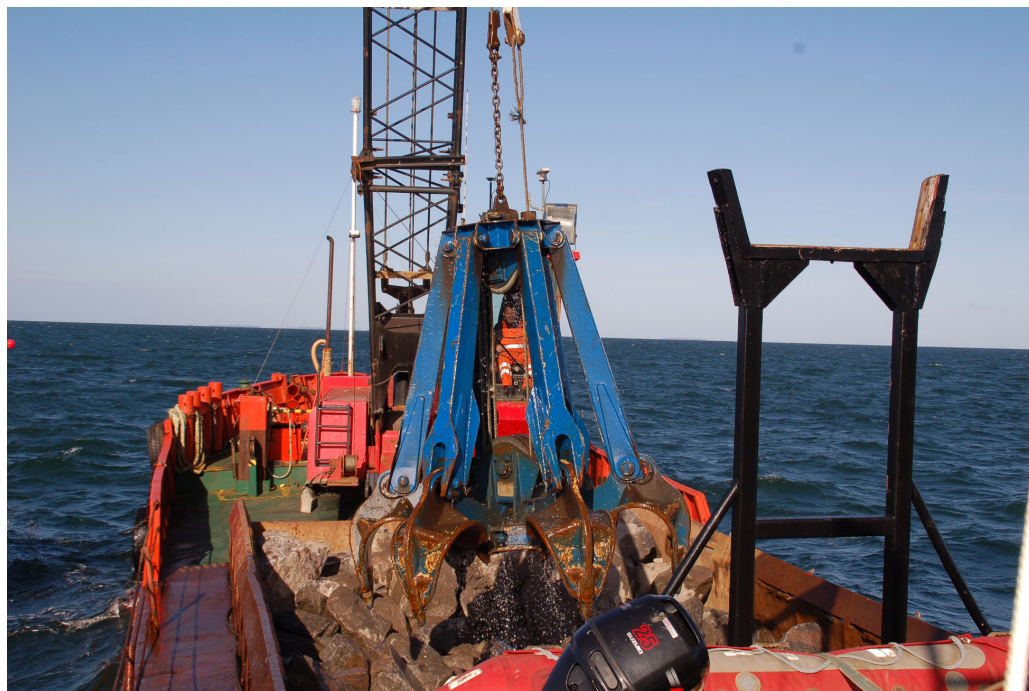
Figura 8: Draga de gajos autoportadora (Lesanco ApS)
