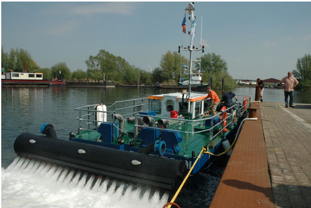
Figura 19: Draga con inyectores de agua (TMS)
