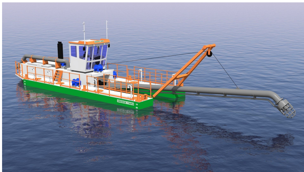
Figura 20: Draga estacionaria de succión ( Dredge Yard )
