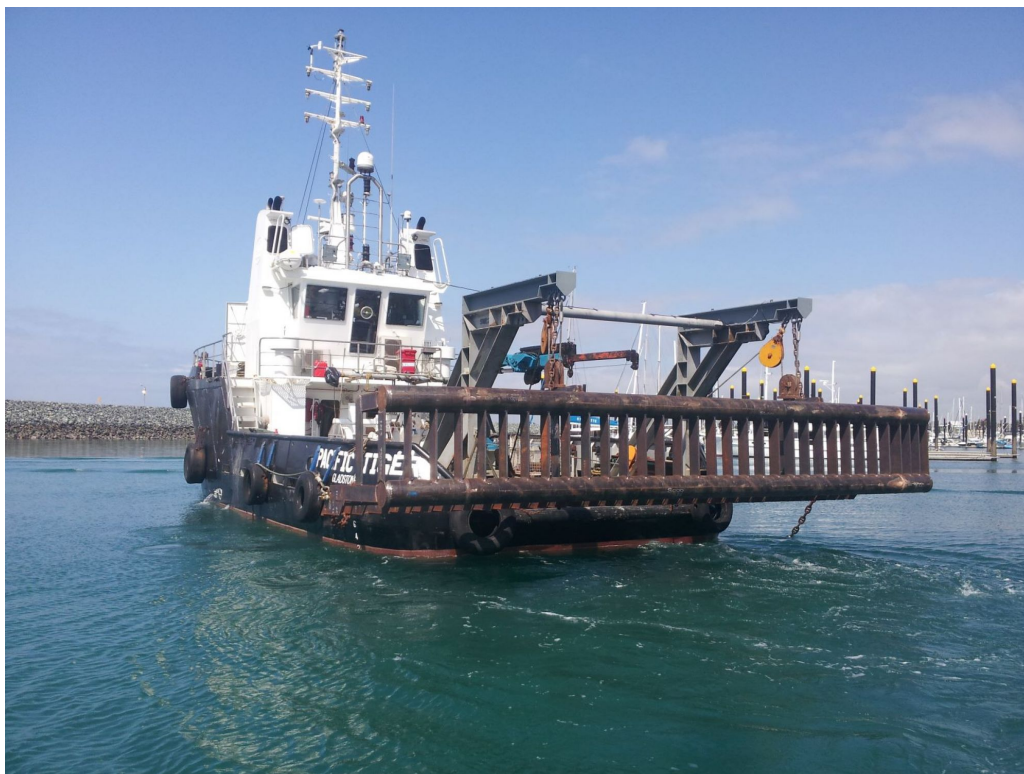
Figura 25: Niveladora de fondo ( Fondico Marine Group )
