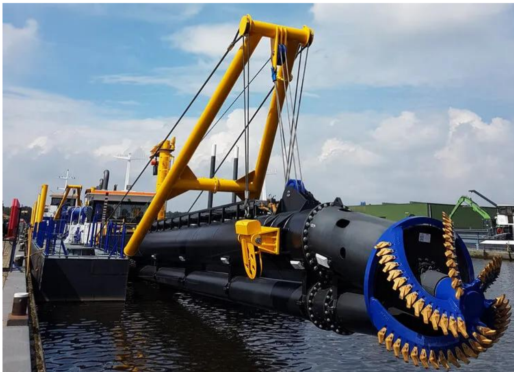
Figura 16: Draga de succión con cabezal cortador (Damen)
